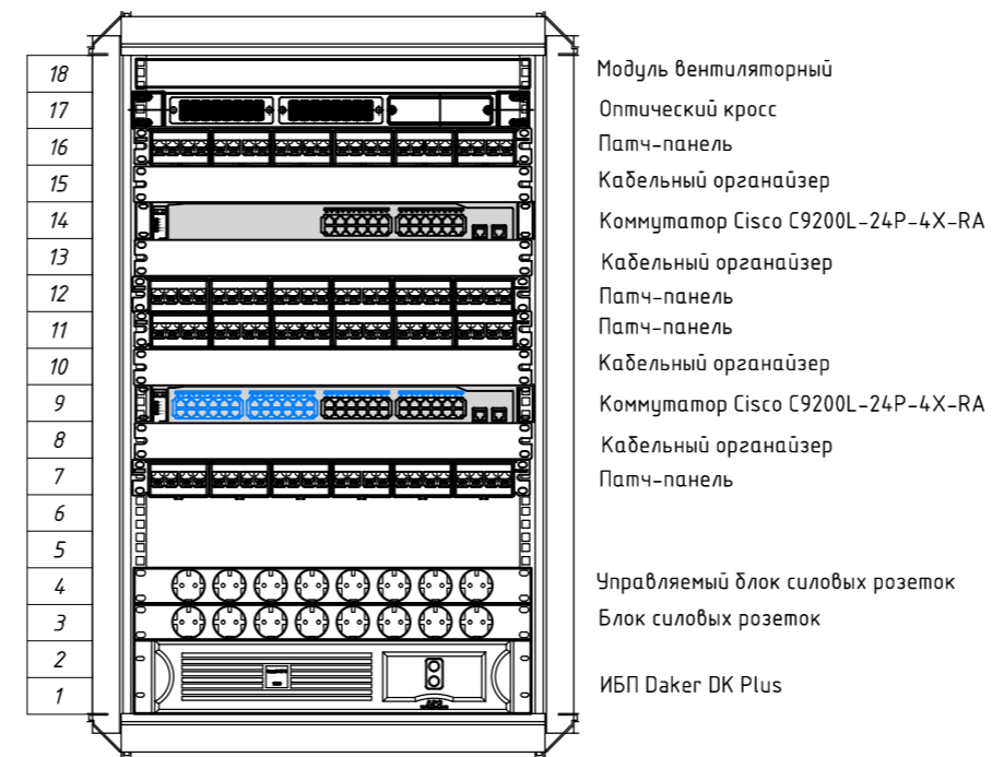
Коммутационная стойка в тех.помещении на -1 этаже КС-3.1
